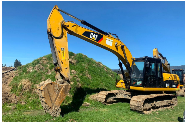
EXCAVADORA TIPO ORUGA
